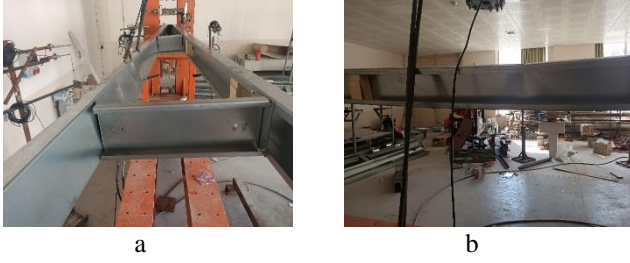
Şekil 7. Deneysel elemanın göçme şekli.
