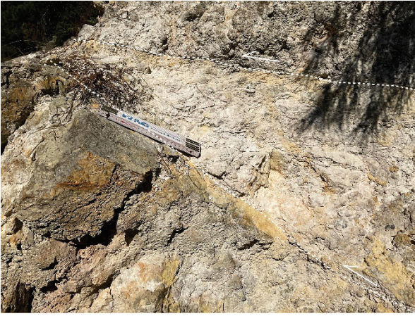
Şekil 10. Üst Kretase kataklastik kayaların bloklu kesimlerinde matriks (ortadaki açık renkli ve yönlenme gösteren kesim) ile bloklar arasında üzerinde yer yer kayma çiziklerinin bulunduğu keskin sınırlar izlenmektedir.
