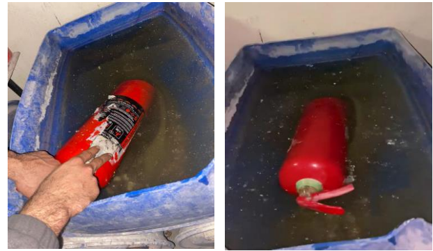
Şekil 23. Etiket Sökülmesi ve Sızdırmazlık Testi Yapılması
