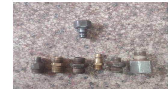
Şekil 18. Dolum Ağızları ve Tetik Sıkma Aparatı [23]
