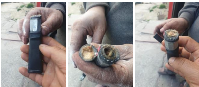
Şekil 30. Lans İçİ Taşlaşma ve Tıkanma
