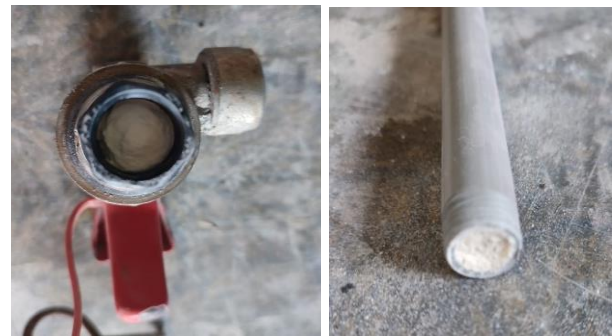
Şekil 31. Tetik ve Hortum İçi Taşlaşma
