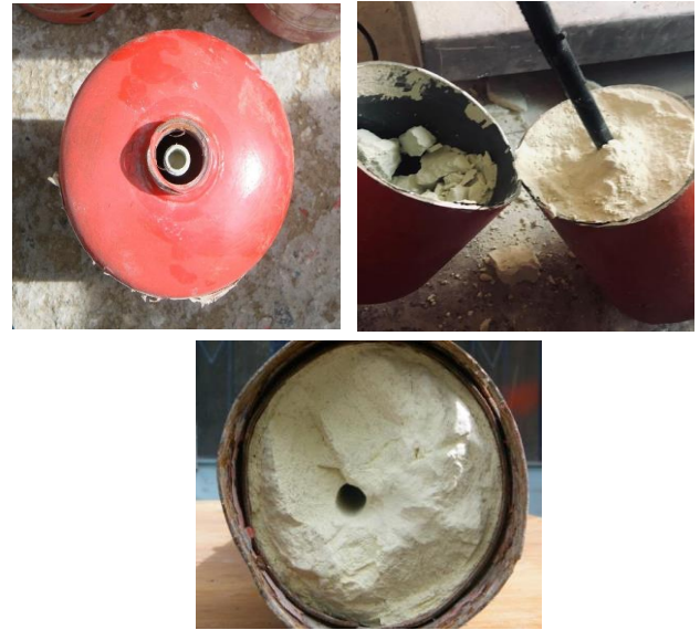
Şekil 28. Taşlaşmış Tüp Resimleri
