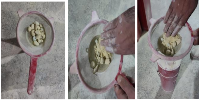
Şekil 20. Uygun Olmayan Taşlaşmış Ürünün Elekten Geçirilerek Kullanımı
