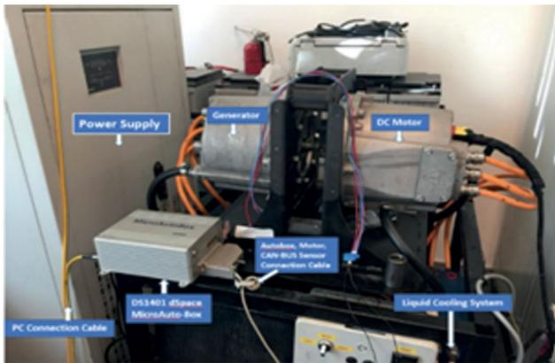
**Figure 28.** System motor-generator test platform with DS1401 dSpace MicroAuto-Box.
