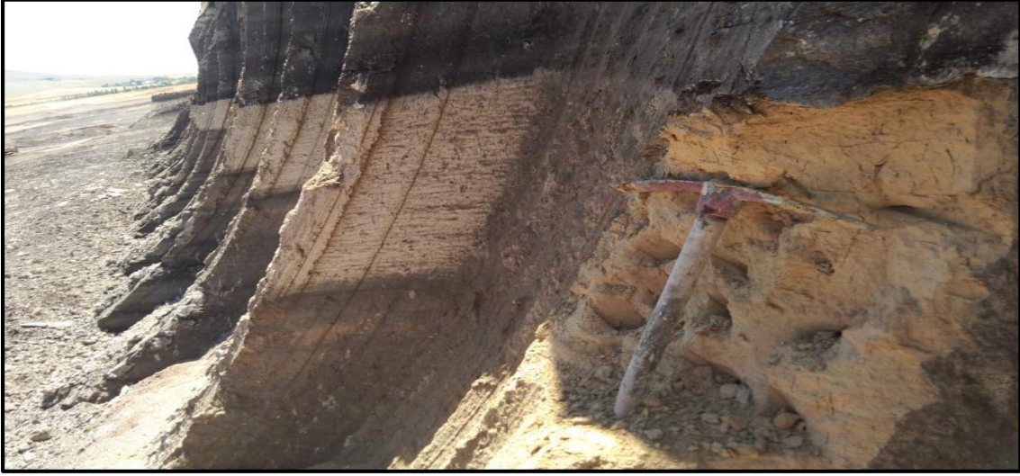
Şekil 2. Afşin-Elbistan linyit havzası Kışlaköy açık işletmesinden kil ve kömür seviyelerinin görünümü
