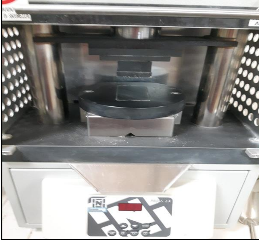
Şekil 9. Kil numunesinin pişme sonrası mukavemet ölçümü.
