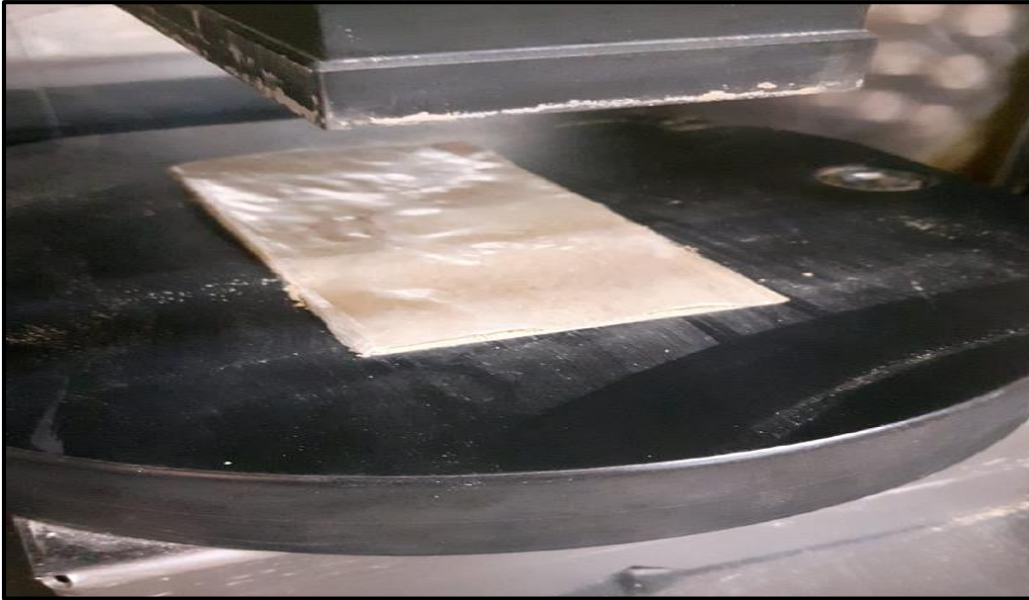
Şekil 8. Kil numunesinin kuru mukavemet deneyi
