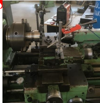
Şekil 1. TIG esaslı IDİ yöntemi deney düzeneği (TIG based HAM method experimental setup)
