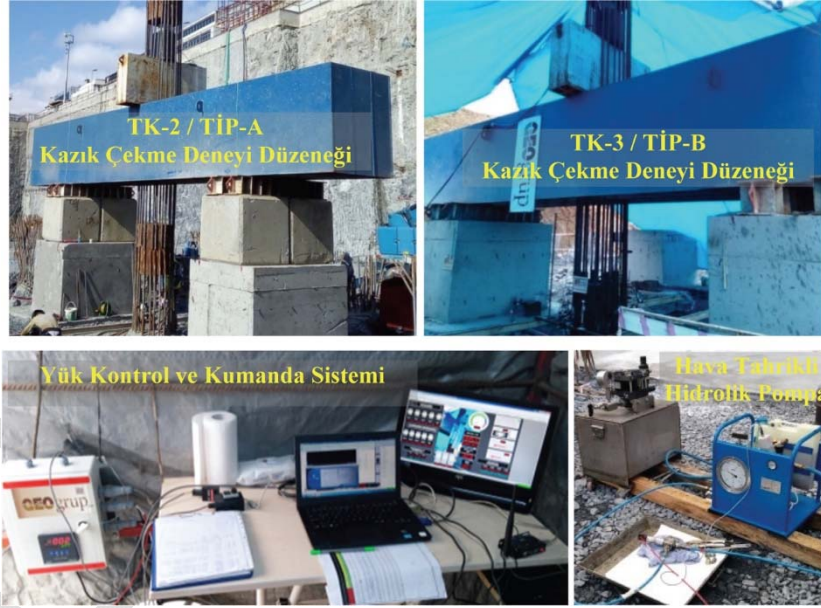
Şekil 7 - Deney düzeneği, yük kontrol ve kumanda sistemi ve hidrolik pompa genel görünüş
