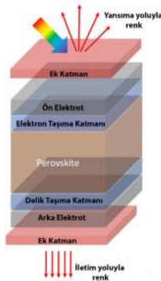
Şekil 37. Perovskite panelin tabakaları (Bing ve diğerleri, 2022).
