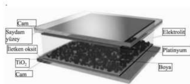
Şekil 32. Boya duyarlı güneş hücresi sistematik yapısı (Ballıpınar, 2012).
