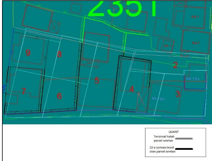
Şekil 6. Ölçme personelinin dikkatsizliği sonucu kadastro planlarında oluşan hataların gösterimi (Osmaniye Kadastro İl Müdürlüğü, 2024).
