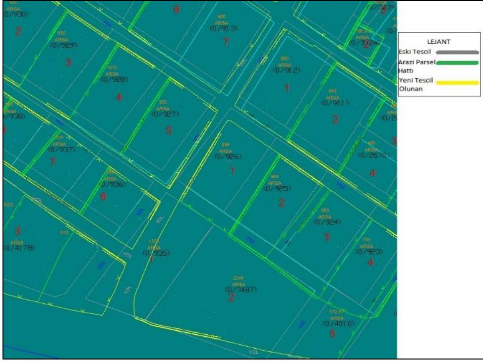
Şekil 4. İmar uygulaması sonucu taşınmaz sınırlarının arazi kullanımıyla örtüşmemesi problemi örneği (Osmaniye Kadastro İl Müdürlüğü, 2024).
