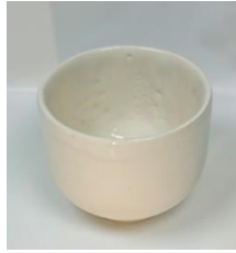
Görsel 9. Hazne 3, ESC-3 döküm kili transparan sırlı pişirim (Kişisel arşiv)
