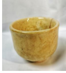
Görsel 12. Hazne 3 , Şamotlu çamur transparan sırlı pişirim (Kişisel arşiv)
