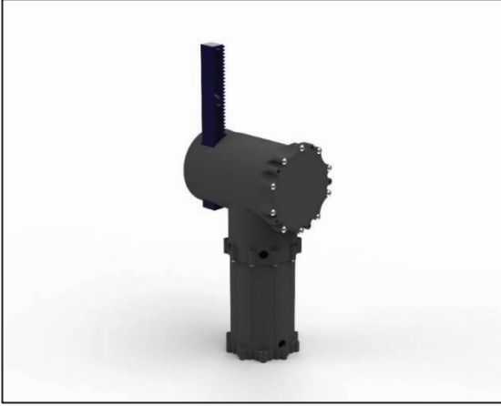
Şekil 4.1 Elektromekanik Rejeneratif Süspansiyon Modülü Prototip Tasarımının İzometrik Görüntüsü
