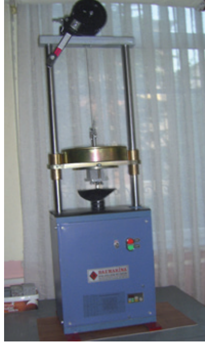
Şekil 2. Sievers minyatür delme deneyi düzeni (Dahl, 2003).
