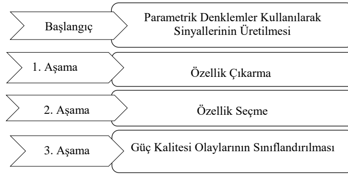
Şekil 1. Güç kalitesi olaylarının sınıflandırılma aşamaları
