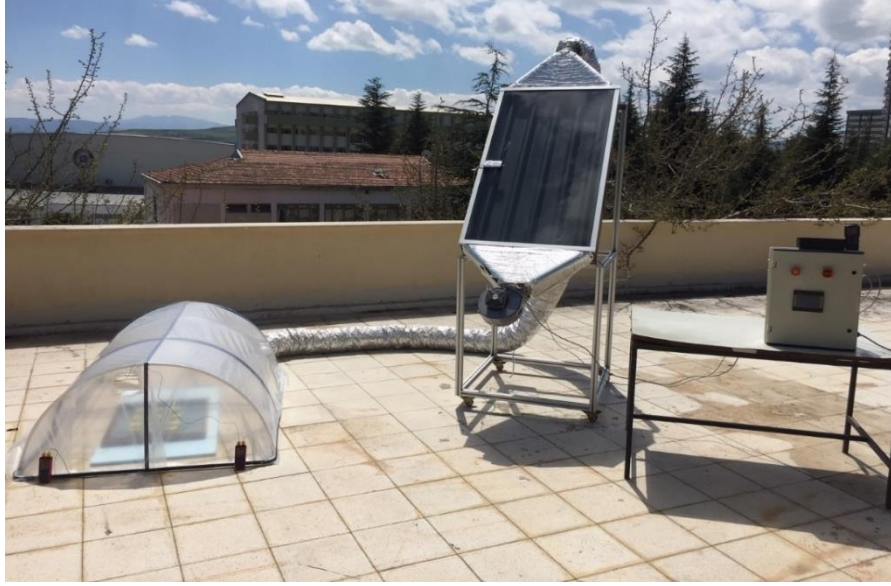
Şekil 1. HGK destekli sera kurutma sistemi. Figure 1. ASC assisted greenhouse drying system.
