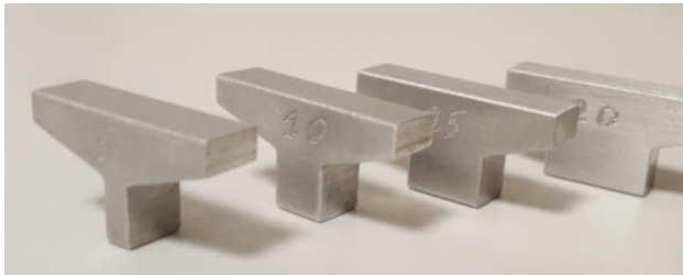
Şekil 4. Sıcak ve soğuk bakır bloklar arasında kalan adiabatik bölgenin uzunluğunu belirlemek için kullanılan mesafe ayarlayıcılar.
