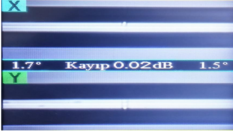
Şekil 3. Tozlu ek yapımı
