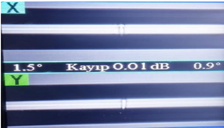
Şekil 5. Kesim hatalı ek yapımı
