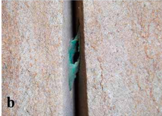
Şekil 12. a) Makaslama Testi, b) Makaslanmış Polimer Saplama
