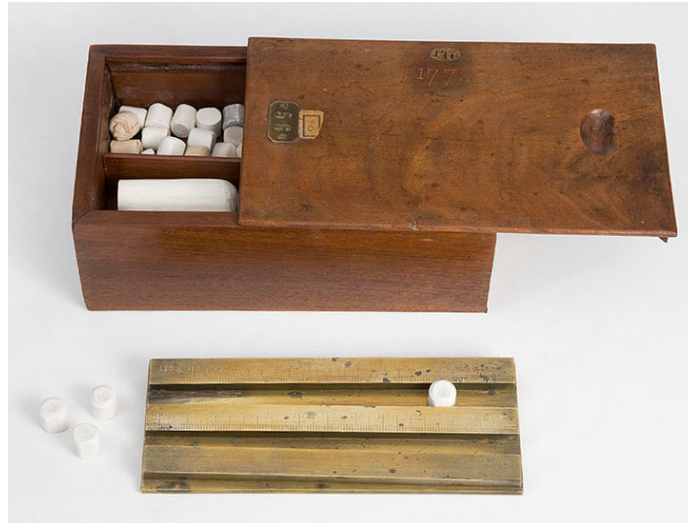
Şekil 6. Josiah Wedgwood, Pirometre , y. 1785, 200 x 119 x 73 mm., Galileo Müzesi, Floransa.
