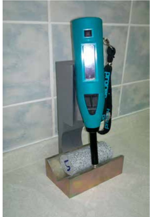
Şekil 4. Kullanılan Schmidt çekici, numune beşiği ve karot numunesi
