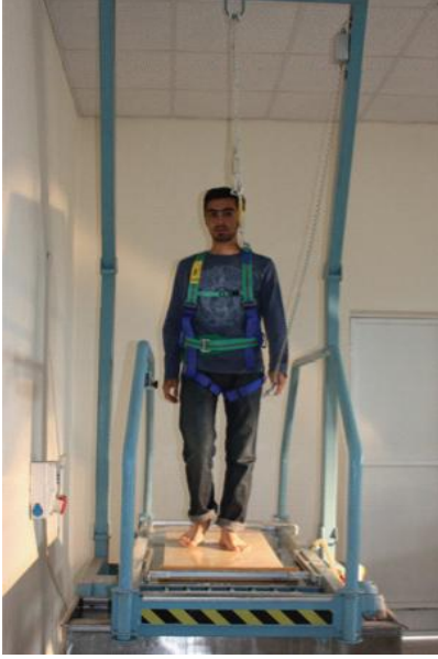
Şekil 1. Eğik düzlem test cihazı.
