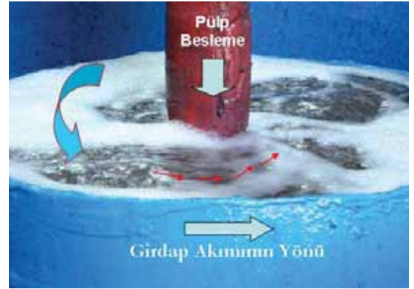
Şekil 5. Hücre yüzeyinde meydana gelen girdap akımının bir görüntüsü.
