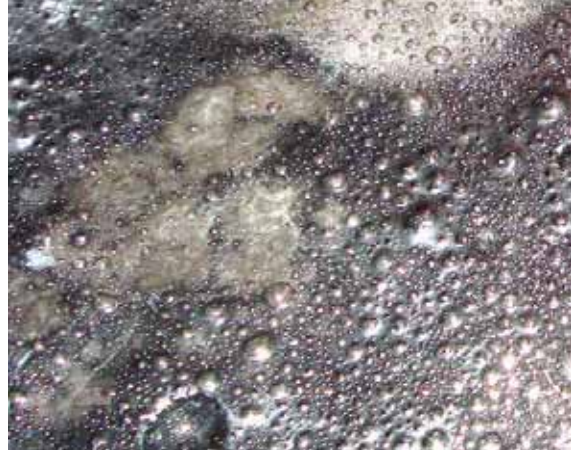
Şekil 9. Santrifüj kuvvetlerinin etkisi ile Siklojet hücresinde oluşan çok küçük çaplı kabarcıklar.
