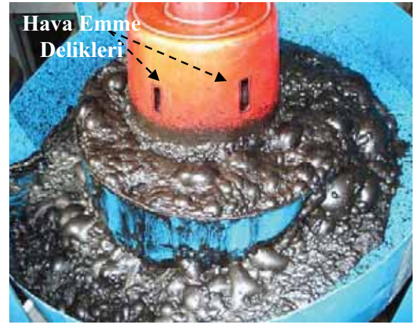
Şekil 4. Konik tüp ve etrafında oluşan kabarcıklar.
