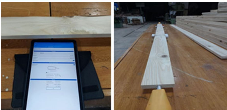
Şekil 1. Akustik test cihazı ile kerestelerin direnç sınıflarının belirlenmesi
