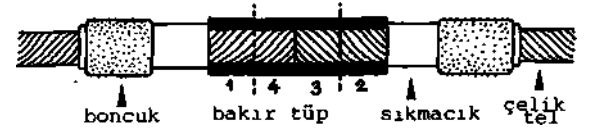
Şekil 3. Bakır tüp bağlantı elemanının sıkma düzeni. Önce tüpün uçları sonra ortalan sıkılır.
