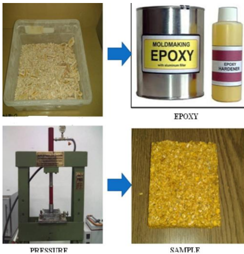
Şekil 1. Karışım işlemi ve presleme
