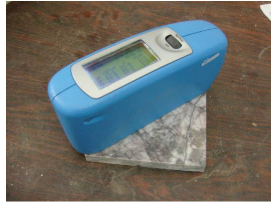
Şekil 8. Parlaklık ölçümlerinde kullanılan glossmetre ölçüm cihazı.
