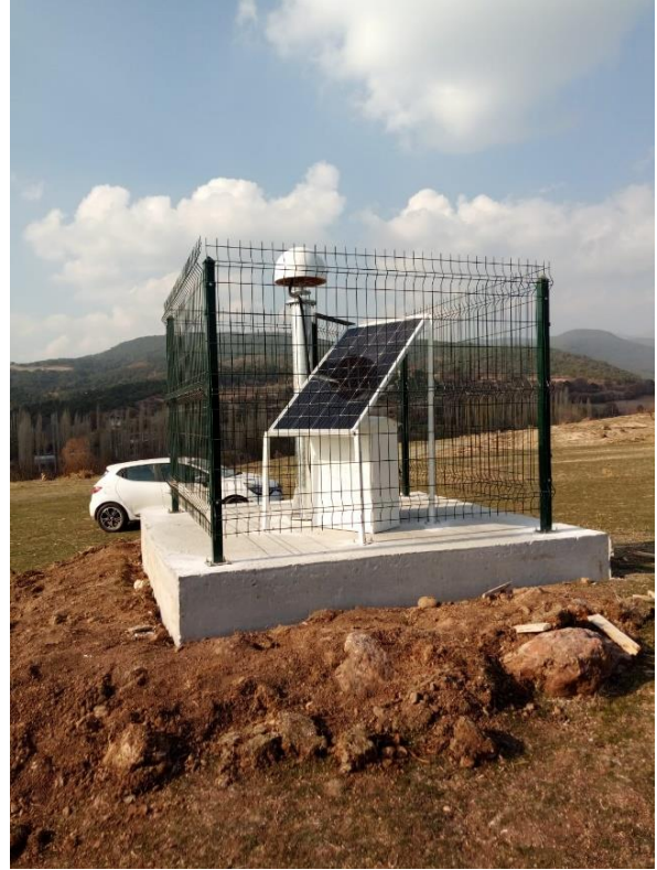
Şekil 2. Banaz Bahadır köyüne kurulan BAHD sabit GNSS istasyonu.
