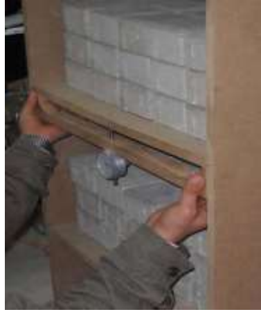
Şekil 9. Sehim ölçümlerin yapılması (Method of deflection measurement) (mm).
