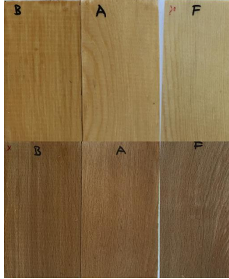
Şekil 6. Hızlandırılmış dış ortam testi öncesi A, B ve F vernikli örneklerinin görüntüsü.
