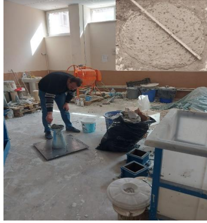
Şekil 3. Çökme deneyi (TS EN 12350-8' e göre)
