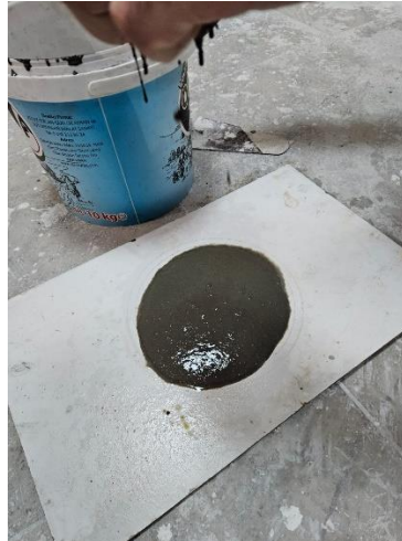
Şekil 2. Çökme deneyi (TS EN 1170-1' e göre)
