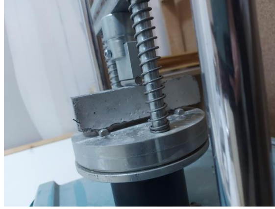
Şekil 6. Eğilme dayanım deneyi
