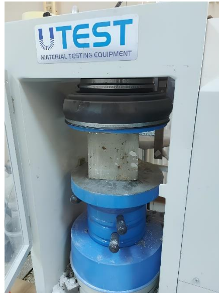
Şekil 5. Basınç dayanım deneyi
