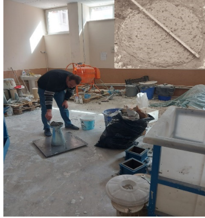
Şekil 3. Çökme deneyi (TS EN 12350-8' e göre)
