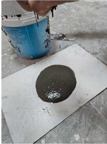
Şekil 2. Çökme deneyi (TS EN 1170-1' e göre)
