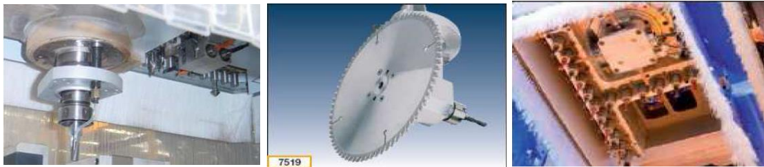
Şekil 7. CNC makinesi Freze, testere ve delik delme ünitesi (CNC machine's drill, saw and router)[3].
