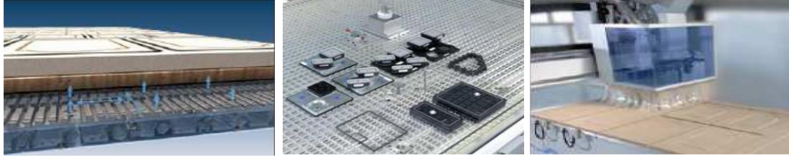
Şekil 8. CNC makinesi tabla vakum üniteleri ve parça işlenmesi (CNC machine table , vacum unit and panel processing)[3].
