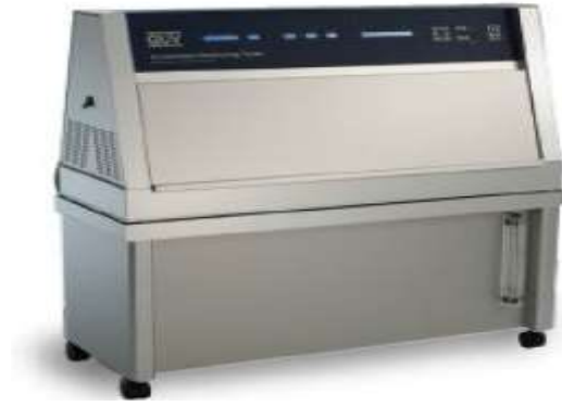
Şekil 1. QUV test kabini (QUV tester cabin) [8]
