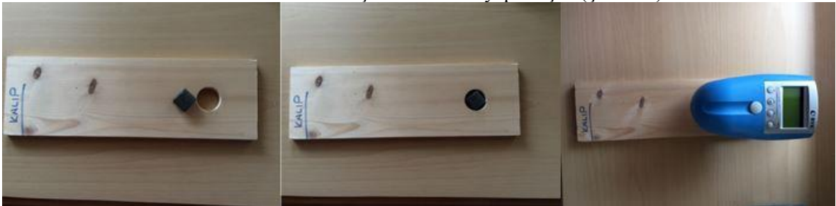
Şekil 13. Parlaklık ölçümü (Gloss measurement)
