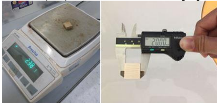
Şekil 11. Retensiyon için ağırlık ve hacim hesaplaması (Weight and bulk calculation for retention)
