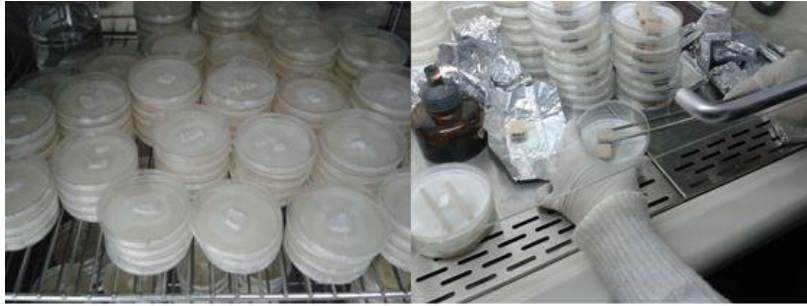
Şekil 8. Mantar misellerinin gelişmesi ve örneklerin petri kaplarına yerleştirilmesi (Growth of fungi mycelium and put on petri pots samples)
