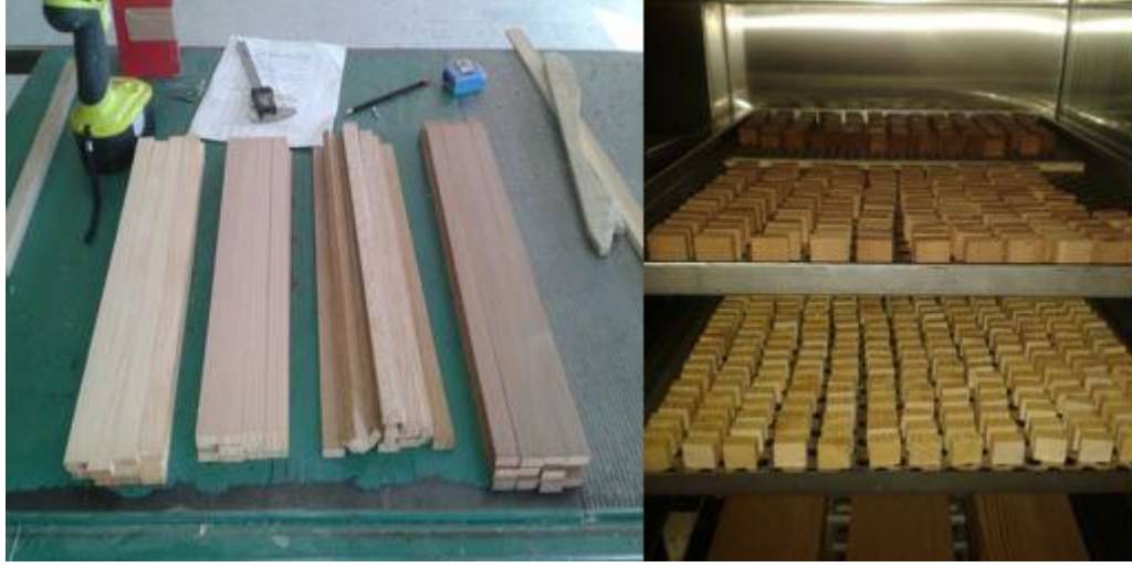
Şekil 1. Örneklerin hazırlanması ve iklimlendirilmesi (Preparation and conditioning of samples)
