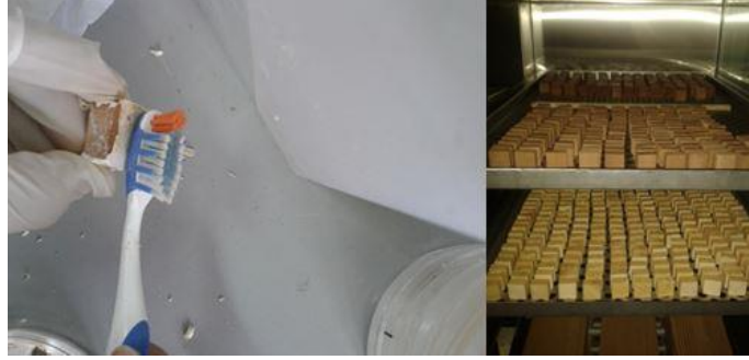
Şekil 10. Mantar misellerinin örnek yüzeyinden temizlenmesi ve kurutulması (Cleaning and drying of the fungi mycelium from the surface of the sample)
