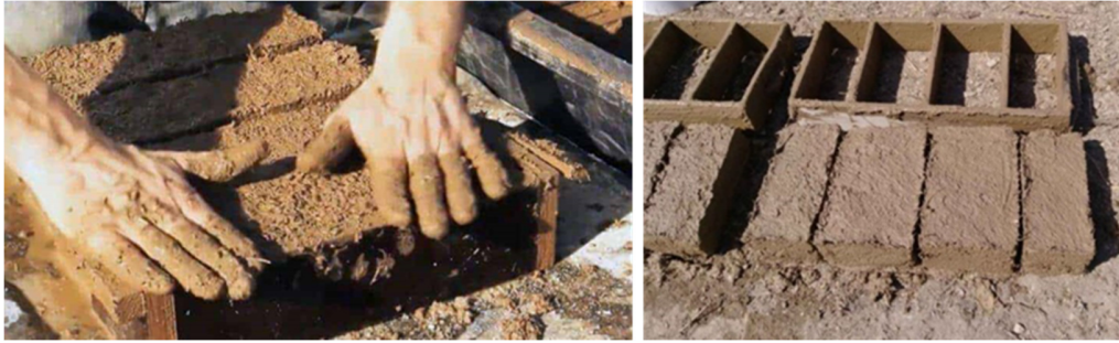
Şekil 5. Kerpiç tuğlası yapımı (Url-10)
