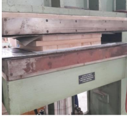
Şekil 1. CLT taslağının preslenmesi (Pressing of CLT panel)
