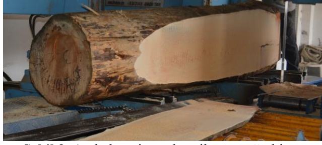
Şekil 2. Arabalı şerit yardımı ile tomruğu biçme
