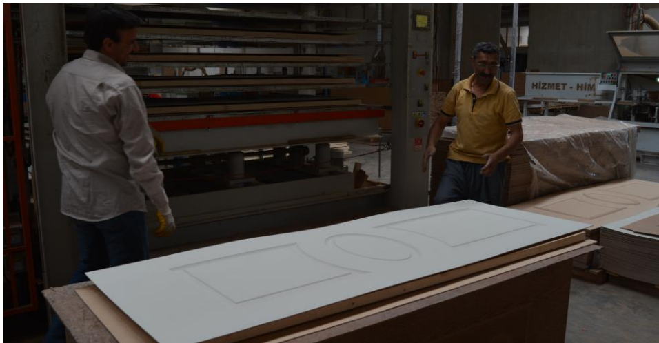
Şekil 11. Panel kapı kanadı presleme
