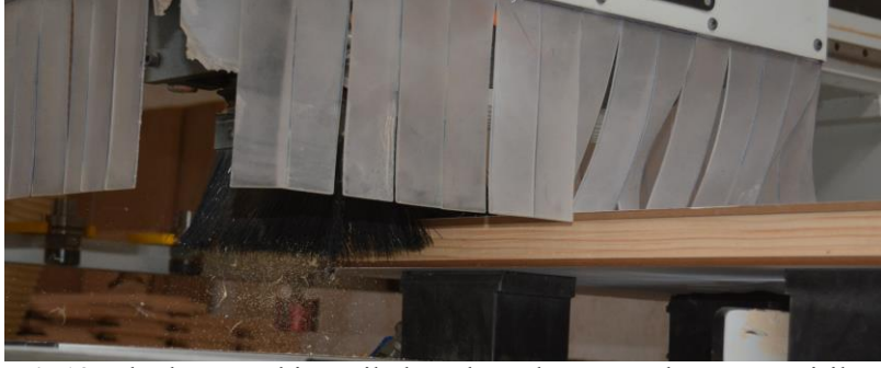
Şekil 12. Ebatlama makinası ile kapı kanadının net ölçüsüne getirilmesi
