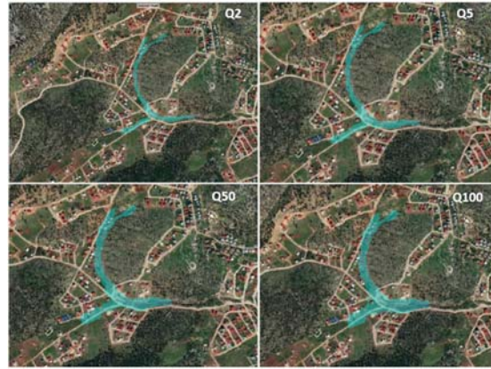
Şekil 10. Ras Mapper kullanılarak Hec-Ras'tan elde edilen akış hızlarının alan bazında dağılımı.
