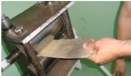
Fot.36: Kuyulmuş gümüşün inceltilmesi , Murat Sahedov Atabayewiç atölyesi,S.Kılıç, Temmuz,2011
