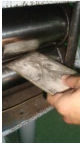
Fot.35: Kuyulmuş gümüşün merdaneye yerleştirilmesi
