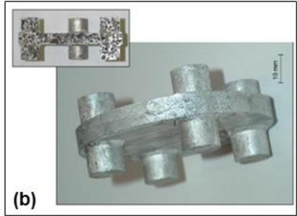
Şekil 11. Gazi Üniversitesi Teknoloji Fakültesi'nde üretilen çeşitli şekillerdeki Al köpükler (a) [27] ve bir kalıpta köpürtülen karmaşık şekilli Al malzeme ve kesit görünümü (b). (Al foams of various shapes produced at Gazi University Faculty of Technology (a) [27] and complex-shaped Al material foamed in a mold and cross-sectional view (b).) [112].
