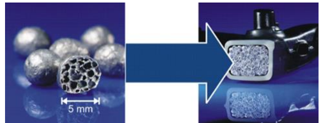
Şekil 17. Frounhofer IFAM'da üretilen küresel köpük malzemeler (Spherical foams produced at Frounhofer IFAM) [131,134,135].
