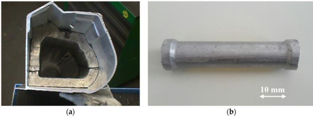
Şekil 32. Alulight tarafından Ferrari 360 ve 430 Spider için geliştirilen Al-köpük sönmleme parçası (a) ve Audi Q7 için geliştirilen küçük çarpışma sönmleme elemanı (b) (Al-foam damping element developed by Alulight for Ferrari 360 and 430 Spider (a) and small crash damping element developed for Audi Q7 (b)) [165].
