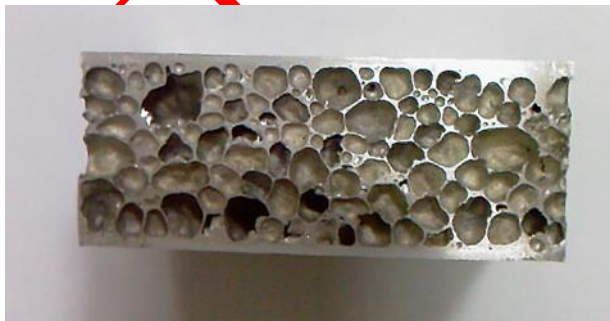
Şekil 15. Al sandviç köpüğün kesit görünümü. (Cross-sectional view of Al sandwich foam).
