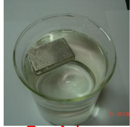
Şekil 2. Düşük yoğunluklu kapalı gözenekli Al köpük (Low density closed pore Al foam)
