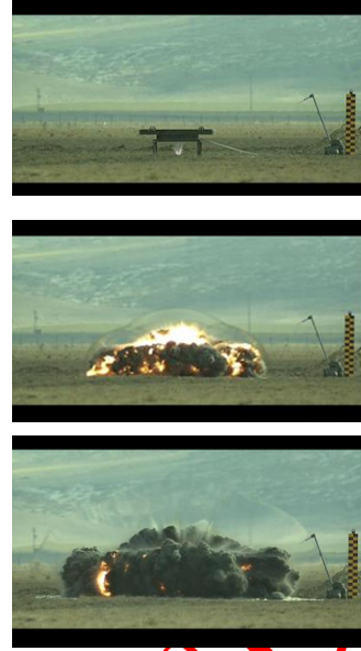
Şekil-36. Nato Stanag standardına göre hazırlanmış olan patlama deney düzeneği (a), (TNT okla gösterilmiştir) ve patlamanın belirli sürelerinden görüntüleri (Explosion test set-up (a), prepared according to the NATO Stanag standard (TNT is indicated by the arrow) and images from certain times of the explosion) [26] [92].
