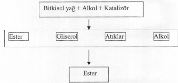
Şekil 1. Bitkisel yağlardan ester elde etme prosesi
