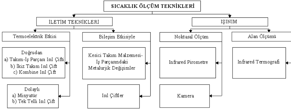
Şekil 1. Kesme bölgesindeki sıcaklıkları ölçmek için geliştirilen yöntemler (5).
