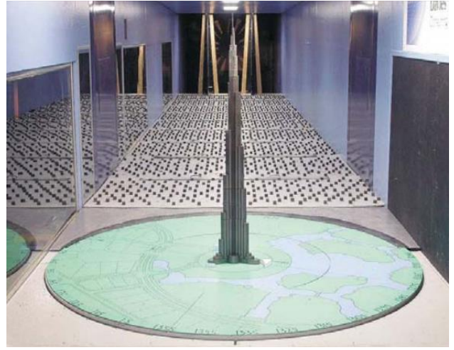
Şekil 31. Aeroelastik Rüzgâr Tüneli Modeli [5].
