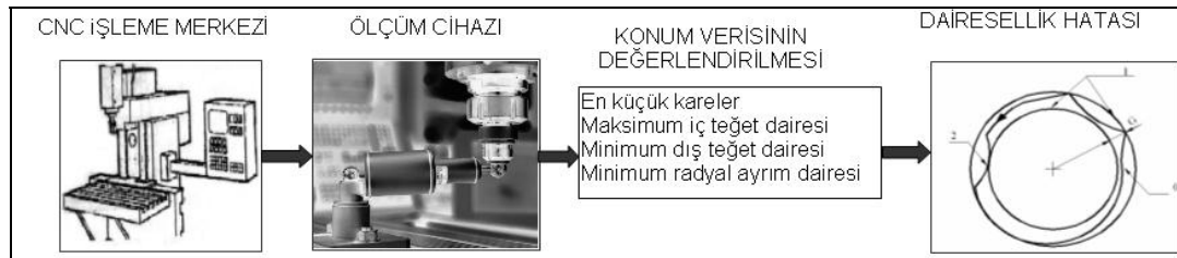
Şekil 1. Dairesellik hatası ölçme sistemi
