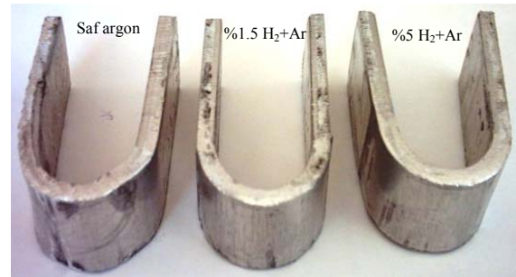
Şekil 2. Eğme deneyi uygulanan numuneler
