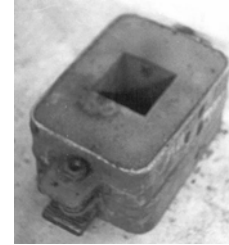
Şekil 4. Boşaltma döküm deneylerinde kullanılan kum kalıplar (10).
