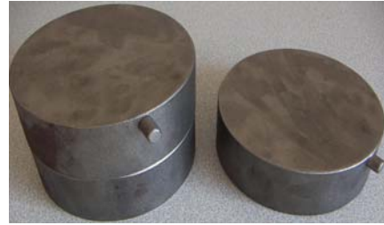
Şekil 9. Deneysel işlenecek olan AISI P20 çelikleri (150 mm çapında).
