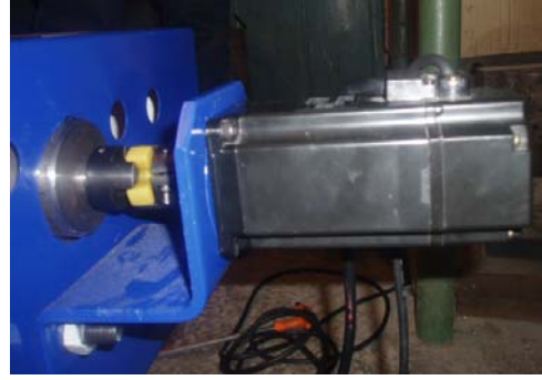
Şekil 5. Servomotor divizör bağlantısı ( C Ekseni)
