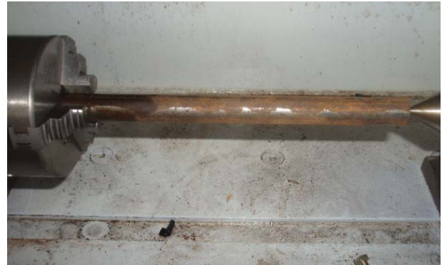
Şekil 17. İşlenecek malzemenin C eksenine takılması
