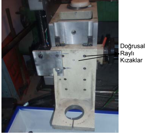
Şekil 8. Z eksenli mekanik imalat şekli
