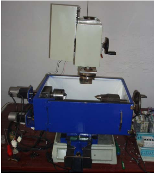
Şekil 9. Mekanik aksam genel görünüm ( X-Y-Z-C eksenli)
