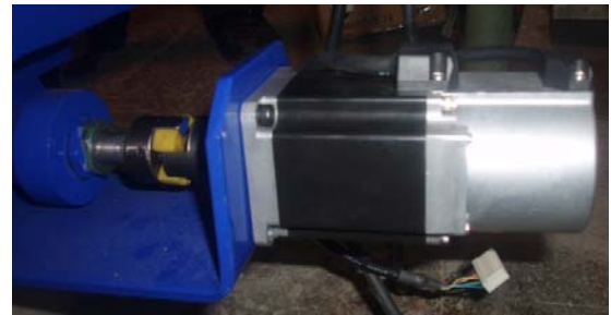
Şekil 7. X eksenini servomotor bağlantısı
