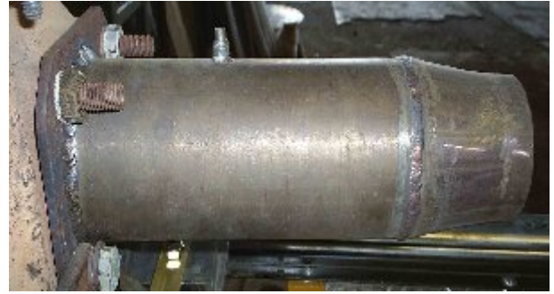
Şekil 6. Model jet motorunun yakınsak egzoz nozulu
