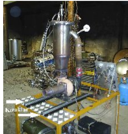
Şekil 7. Kızaklar ve üzerine monte edilmiş model jet motoru
