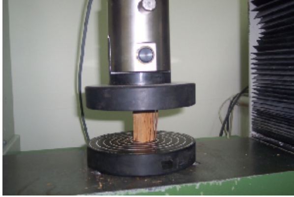
Şekil 2. Numunelerin liflere paralel doğrultuda basınç dayanımının tayini, TSE İnşaat Laboratuvarı, Ankara.
