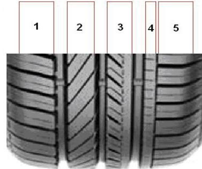
Şekil 1 Referans lastiğin hesaplamalar için parçalara ayrılmış bölümleri (The reference for the calculations fragmented parts of the tire)
