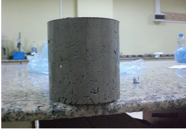
Şekil 1. Sıkıştırma işlemi yapılmış bir zemindeki hava boşlukları
