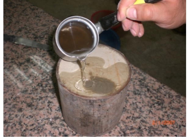
Şekil 3. Sıkıştırılmış zemin numunesinin alt, üst yüzeyinin parafin ile kapatılması
